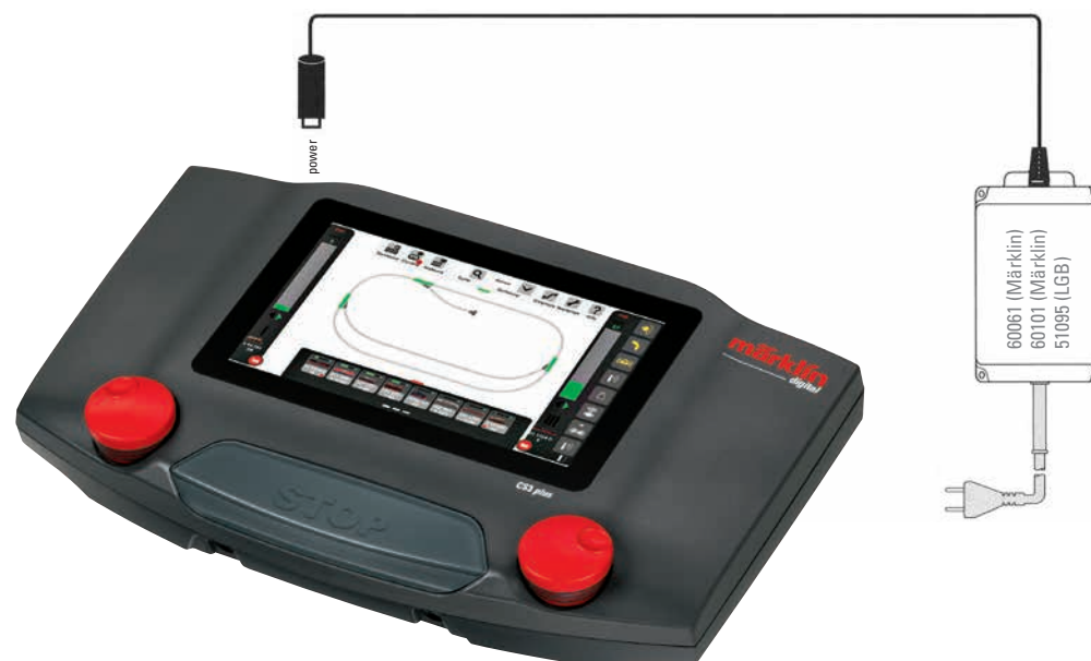
Aansluiting stroomvoorziening Central Station
